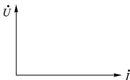
图 2.18 纯电感电路 电压、电流相量图
