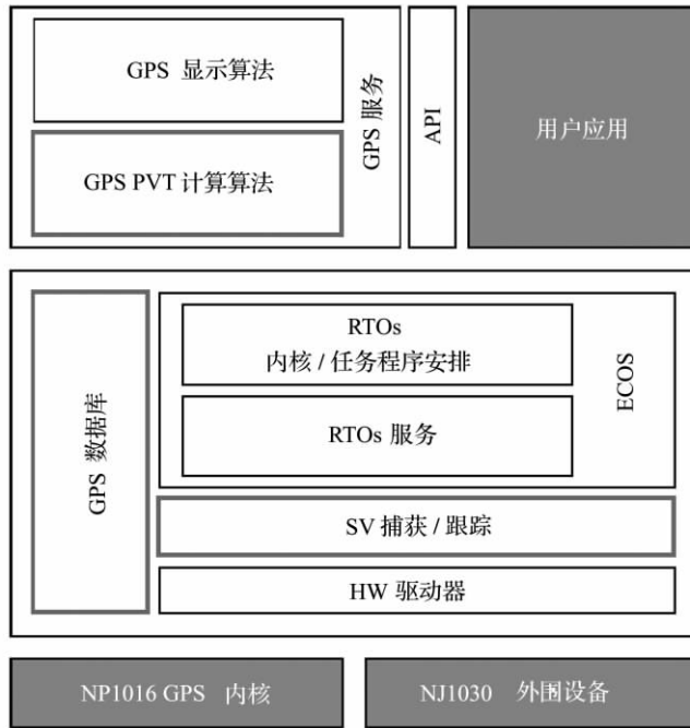
图 2-14 SW1030 软件体系结构
