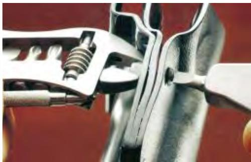
▲ 在拆分东西时用扳手固定螺母，用螺丝刀拧螺丝。
