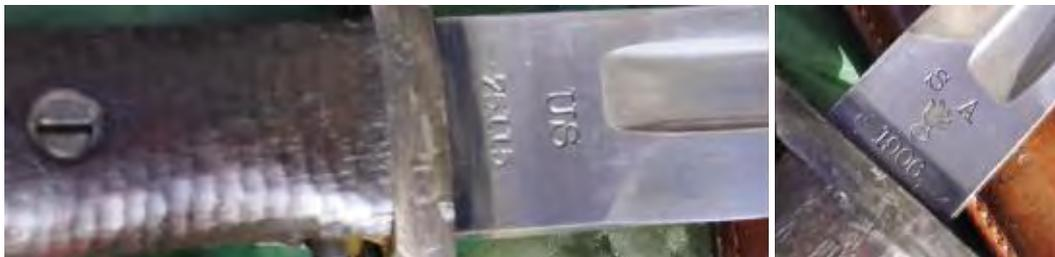
▲ M1905 刺刀一侧为厂标、炸弹图形及年份标识，另一侧为 US 标识和工厂生产序号。
