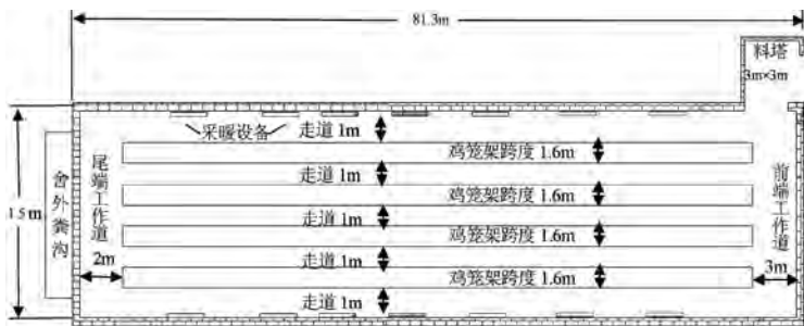
图 2-11 3 万只育雏育成鸡舍建筑平面图
