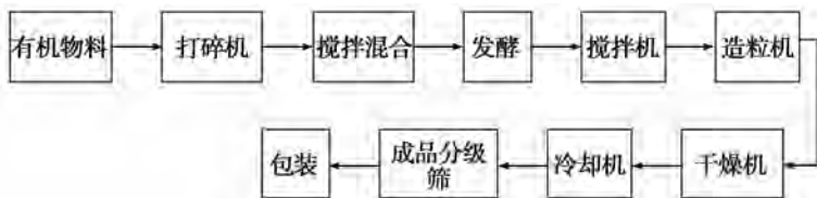
图 3-13 用牛粪生产有机肥的工艺流程图
