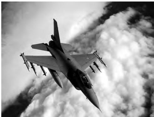
机身半硬壳结构，采用翼身融合体的设计，使机身与机翼平滑连接，不但可减小飞行阻力，提高升阻比，而且对结构强度有好处，可减重 258 千克，也对减小雷达反射面积很有好处。尾部有全动式平尾，平面形状与机翼相似，翼根整流罩后部是开裂式减速板。垂尾较高，安定面大，后缘是全翼展的方向舵。腹部有两块面积较大的安定翼面。起落架为可收放的前三点式。座舱盖为气泡形的，飞行员视野很好，内装零—零弹射座椅。控制系统采用四余度电传操纵技术，主要由信号转换装置、飞行控制计算机、电缆和动作装置组成。
