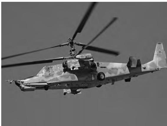
卡-50主要用于完成反坦克任务，此外还可用来执行反舰/反潜、搜索和救援、电子侦察等任务。卡-50采用了很多先进技术，如红外抑制技术、红外诱饵撒布装置和装甲、先进的火控技术。1996年，卡莫夫设计局公开了卡-50的双座型卡-52，俄军将其命名为“短吻鳄”。
