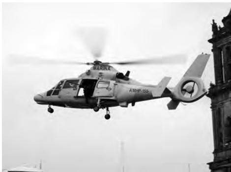
“海豚”直升机采用了大量复合材料，涵道式尾桨提高了安全性，起落架为前三点可收放式，机载设备比较先进，可执行多种任务。包括我国在内的许多国家，都引进了“海豚”直升机。
