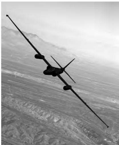
21 000 米的高空飞行、照相、使用雷达侦察及截听通信。主要用于执行战略或战术的照相和电子侦察任务。1956 年开始装备美空军。机长 15.11 米，机高 3.96 米，起飞重量 7384 千克，最大飞行速度 804 千米/时，最大升限 2.134 万米，航程 4180 千米，机载设备有：8 台照相侦察用的全自动照相机，能全天候工作且分辨率高，4 部实施电子侦察的雷达信号接收机、无线电通信侦察机、辐射源方位测向机和电磁辐射源磁带记录机等。
