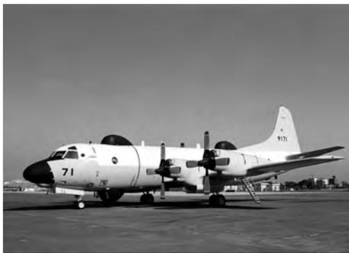
EP-3 是美国的一种陆基情报侦察机，机上配备了尖端的电子信息拦截系统，它可以探测并追踪雷达、无线电以及其他电子通信信号。它具有全天候侦察的能力，机动性较强，能迅速地提供所需情报。该型机的主要缺陷是无法进行空中加油，因此不得不依靠他国的基地才能进行空中侦察。
