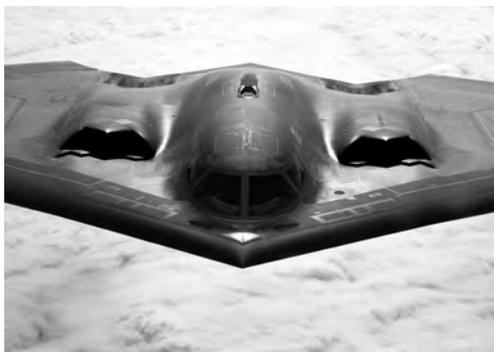
B-2A 隐身性能首先来自它的外形：采用翼身融合的扁平无尾飞翼机体，机翼前缘为直线，机翼后掠  $33^\circ$ ，飞机头部到翼尖成锐角，机翼后缘成双“W”锯齿形，外形像一只巨大的黑蝙蝠。巨大的锯齿状后缘由 10 条直的边缘组成，从而可使雷达波从后缘和上沿两个方向反射出去，以较大的
