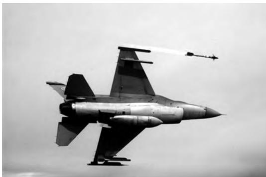
参加海湾战争的 F-16 战斗机还进行了“准隐身改造”，座舱盖、风挡镀了薄金属膜，翼面前缘、进气口等部位涂有反雷达涂层，使得 F-16 雷达反射面积减到了 1 平方米。F-16 存在的主要问题是，作为低档配置，它的空战能力与专门的空中优势战斗机无法相
