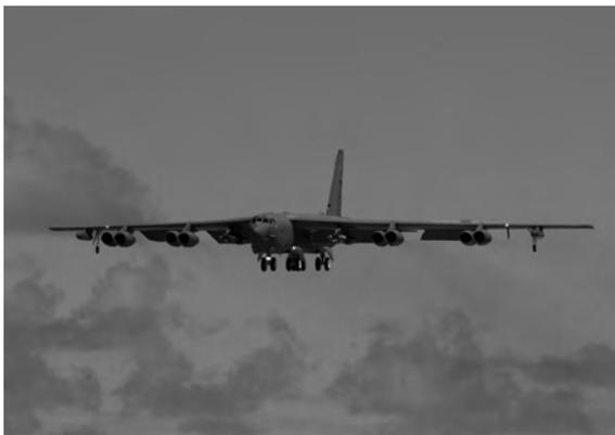
B-52 翼下装四组八台涡轮喷气发动机，两台发动机间装有防火隔层，每台发动机都装有马鞍形滑油箱。两个外挂点和两个副油箱外挂点。机头下的两个突起物是红外夜视仪器，用于夜间或恶劣气候条件下低空突防和确定目标。B-
