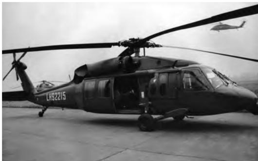
“黑鹰”作为突击运输直升机在执行低飞作战任务时，极易遭受地面火力攻击，故该机在提高生存力方面采取了很多措施。例如，其机身及旋翼在制造上大量使用各类防弹材料，驾驶舱和发动机的关键部件均设有装甲；两台发动机由机身隔开，相距较远，如有一台被击中损坏，另一台仍可继续工作。而“黑鹰”的抗坠毁措施尤其值得一提，它采用固定式抗坠毁起落架、机身下部的蜂窝状填料，以及高效减震座椅等。
