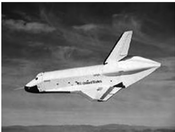
尔总装大楼。这架编号为 101，取名“企业号”的航天飞机是美国航天飞机计划中第一架原型机。“企业号”航天飞机长 37.2 米，宽 23.8 米，高 17.4 米，空重 72.6 吨，载荷舱长 18.2 米，宽 4.6 米，能将 29.5 吨重载荷送上 370 ~ 1110 千米高的空间轨道，并可从空中带回 1.45 吨重
