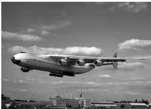
为后掠式，由中央翼段和安-124 机翼组成。两个垂直尾翼安装在带上反角的水平尾翼两端，所有翼面都后掠。起落架为液压操纵可收放前三点式。机长 84.00 米，机高 18.20 米，翼展 88.40 米。动力装置为翼下吊挂 6 台 D-18T 涡轮风扇发动机，单台推力 229.5 千牛，有反推力装置。最大起
