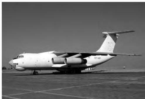
为适应粗糙的前线机场跑道，伊尔-76采用了低压起落架系统，以及能在起降阶段低速飞行时提供更大升力的前后襟翼。伊尔-76还具有改装成飞行医院的能力。采用液压可收放前三点式多轮低压轮胎起落架，共20个机轮。轮胎装有胎压调节系统，飞行中可调节所需要的胎压。
