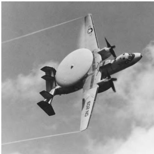
同时，海军于 2002 年开始部署一种新版本 E-2D 先进鹰眼飞机。主要是进行了重要的雷达和航空电子设备的升级。E-2D 飞机希望能够在 2011 年形成初始作战能力。E-2D 飞机的核心是 ADS-18 电子扫描阵列雷达。E-2D 将进行多项改进和升级，包括座舱内战术显示器、一个改进的机身、新的发动机驱动发电机和新的发动机传动箱。诺思罗普·格鲁曼公司在 2007 新年开始进行 2 架 E-2D 发展
