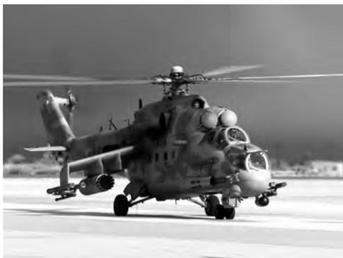
米-24装有2台卡里莫夫TV3-117涡轴发动机，每台功率为1633千瓦。武器系统包括一挺遥控4管“卡特林”12.7毫米机枪，储弹量1470发，4枚AT-2“蝇拍”式反坦克导弹，多种火箭、炸弹、布雷器，最多可装1500千克常规炸弹，试装AA-8“蚜虫”、AA-11“射手”空空导弹。
