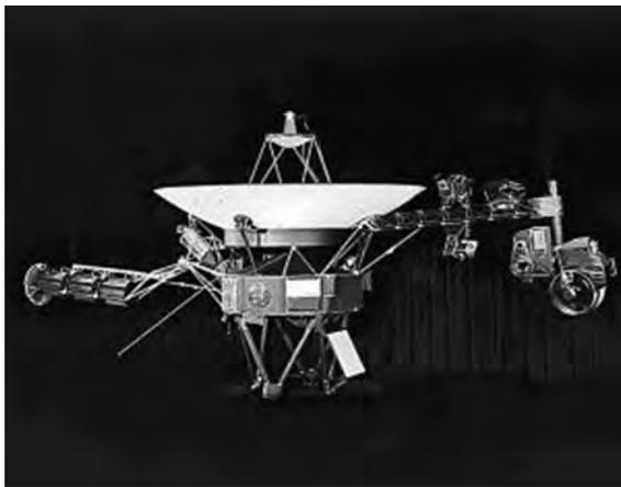
“旅行者 1 号”，原名为美国“水手计划”中的“水手 11 号”，是一艘无人外太阳系核动力太空探测器，携带有 105 千克科学探测仪器。它的主体是扁平的十面棱柱体，顶端装有一直径为 3.7 米的抛物面天线，左右两侧各伸出一根悬臂，较长的一根是磁强计支柱，短的一根是科学仪器支架。它的飞行速度
