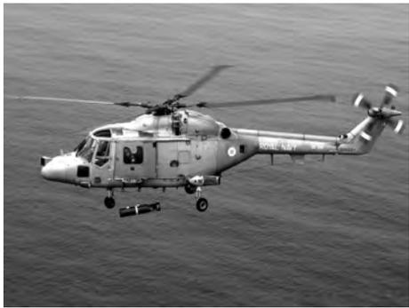
“山猫”作为一种多用途的军用直升机，到目前为止已有20种不同改进型。其中主要有：“山猫”AH-Mk1，英国陆军通用型；“山猫”HAS-Mk2，英国海军轻型反潜反舰直升机；“山猫”HAS-Mk3，加大功率的英国海军型；“山猫”HAS-Mk3GM，英国海军阿拉伯海湾巡逻型。
