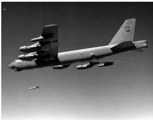
实用升限：15 151 米；最大航程：14 080 千米（无空中加油）；带 4540 千克弹药时作战半径是 4880 英里（7854 千米）；机组：5 人。
