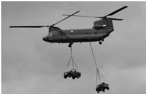
**双旋翼直升机：**纵列式（Tandem）两个旋翼前后纵向排列，旋转方向相反。例如，美国波音公司制造的 CH-47 “支努干” 运输直升机。
