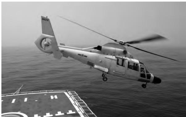
直-11 的尺寸数据：旋翼直径 10.69 米，尾桨直径 1.86 米，机身长 11.24 米，机全长 13.01 米，机高 3.14 米。重量及载荷数据：空重 1253 千克，最大起飞重量 2200 千克，正常起飞重量 2000 千克。性能数据：最大平飞速度 278 千米/小时，巡航速度 292 千米/小时，航程 600 千米，续航时间 3.7 小时。
