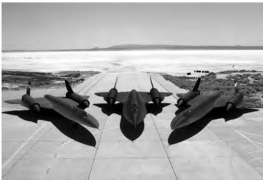
20世纪50年代，侦察机的飞行性能显著提高，飞行速度超过音速，机载侦察设备也有很大改进。拍摄目标后几十秒钟就能印出照片，并可用无线电传真传送到地面。还出现了一些专门研制的侦察机，如美国的U-2侦察机。20世纪60年代研制出3倍音速的战略侦察机，如美国的SR-71侦察机，其最大飞行速度超过M3.0，实用升限达25千米左右，照相侦察1小时的拍摄范围可达15万平方千米。20世纪80年代初，有的国家就开始着手研制飞行速度为M5.0左右、升限超过3万米的高空高速侦察机。无人驾驶侦察机将得到更广泛的应用。
