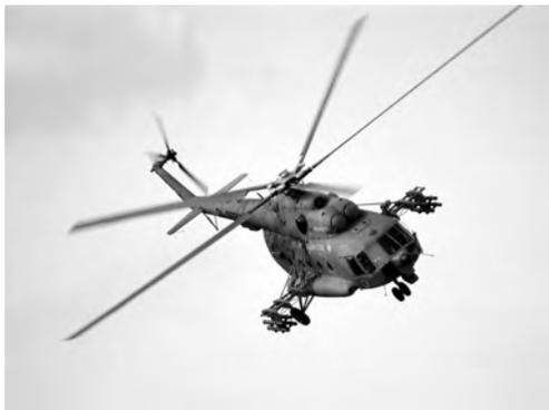
直升机的突出特点是可以做低空（离地面数米）、低速（从悬停开始）和机头方向不变的机动飞行，特别是可在小面积场地垂直起降。由于这些特点使其具有广阔的用途及发展前景。在军用方面已广泛应用于对地攻击、机降登陆、武器运送、后勤支援、战场救护、侦察巡逻、指挥控制、通信
