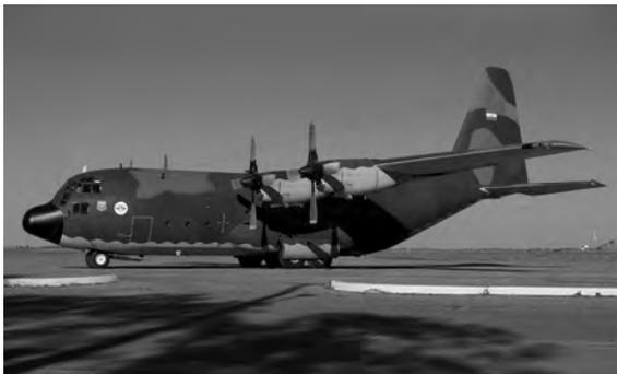
尺寸数据：翼展40.41米，机长29.79米，机高11.66米，机翼面积162.12平方米，机舱（不含驾驶舱）长12.6米、宽3.13米、高2.18米，主轮距4.35米，前主轮距9.77米。
