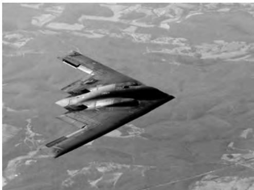
B-2 的动力装置是 4 台通用电气公司的 F118-GE-110 无加力式涡扇发动机，单台发动机的最大单位推力可达 7854 千克。这样强大的动力系统使 B-2 飞机能进行超音速飞行，并保证 152 635 千克的最大起飞重量。B-2 在不进行空中加油的情况下，作战航程可达 1.2 万千米，如果在空中加油一次
