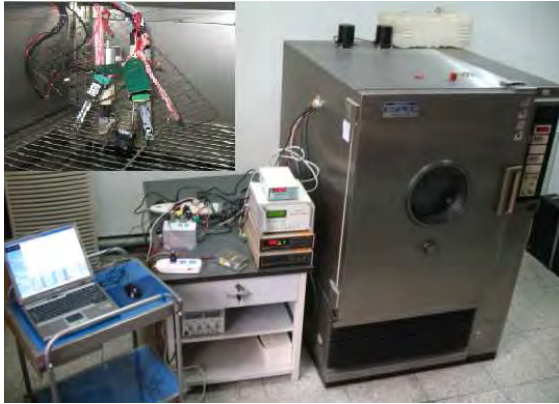
图 6-1 国家气象计量站对 TF-1 无人机气象探测系统进行温湿度计量测试 (左上角为内部传感器布置图)
