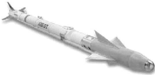
图4-3 响尾蛇被动式空空导弹
