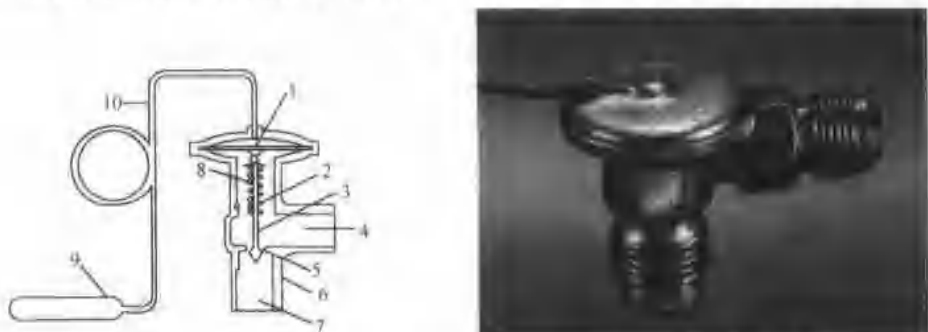
1-膜片；2-内平衡口；3-针阀；4-蒸发器出口；5-阀座；6-阀体；7-通储液罐的进口；8-弹簧；9-遥控温包；10-毛细管
