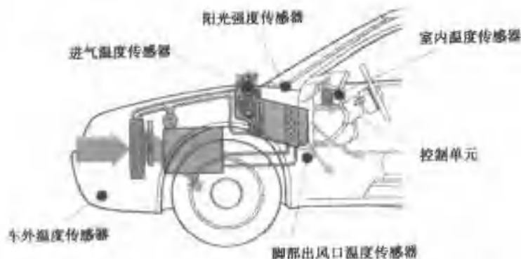
图 6.47 汽车自动空调的主要温度传感器及位置示意图
