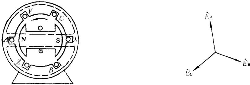
图 16-6 三相同步发电机示意图
